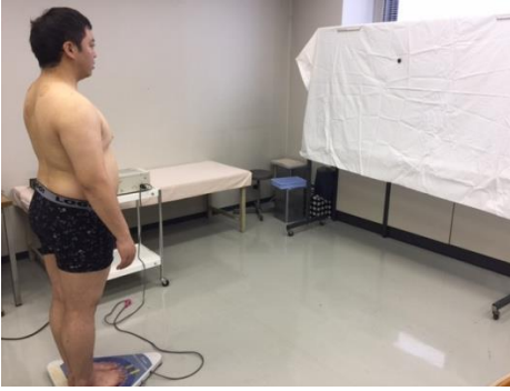
図7 静止立位の重心動揺の計測
