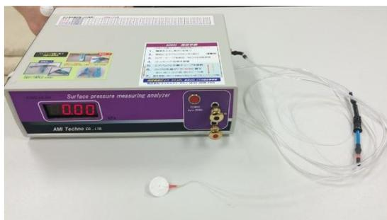
図 2 包帯圧力測定器
